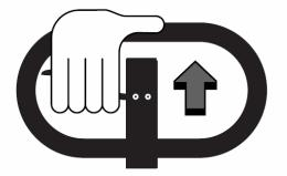
THEN SET CONTROL LEVER TO PUMP POSITION AND PUMP HANDLE NORMALLY TO LIFT LOAD.
